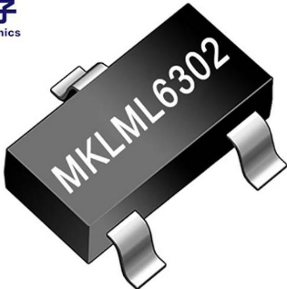
耗尽型与增强型MOS管的区别详解耗尽型与增强型MOS管的区别主要在于耗尽型MOS管在G端（Gate）不加电压时有导电沟道存在，而增强型MOS管只有在开启后，才会出现导电沟道；两者的控制方式也不一样，耗尽型MOS管的VGS（栅极电压）可以用正、零、负电压控制导通，而增强型MOS管必须使得VGS>VGS<sub>th</sub>（栅极阈值电压）才行。耗尽型与增强型MOS管简述场效应管分为结型场效应管（JFET）和绝缘栅场效应管（MOS管）两大类。按沟道材料型和绝缘栅型各分N沟道和P沟道两种；按导电方式：耗尽型与增强型，结型场效应管均为耗尽型，绝缘栅型场效应管既有耗尽型的，也有增强型的。场效应管的工作方式有两种：当栅压为零时有较大漏极电流的称为耗尽型；惠州贴片场效应管生产厂家
