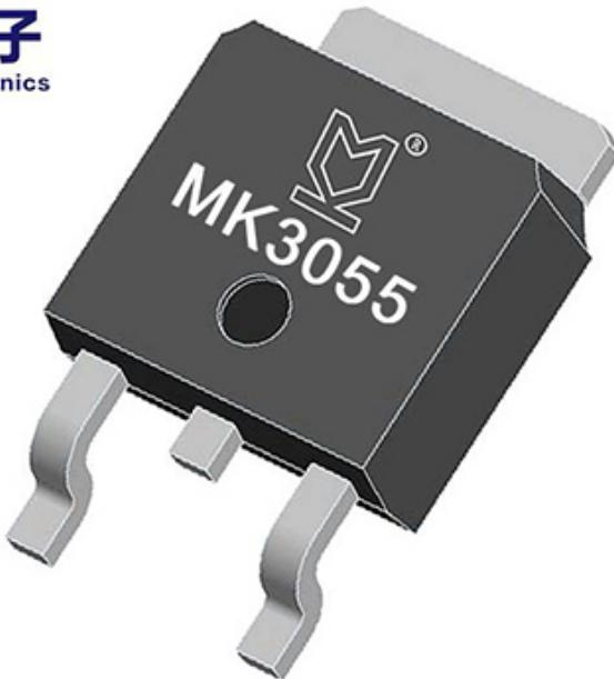
为了安全地使用场效应管，在线路的设计中不能超过管子的耗散功率。比较大漏源电压、比较大栅源电压和最大电流等参数的极限值。各类型场效应管在使用时，都要严格按要求的偏置接入电路中，要遵守场效应管偏置的极性。如结型场效应管栅源漏之间是PN结。**N**沟道管栅极不能加正偏压，**P**沟道管栅极不能加负偏压等等。**MOS**场效应管由于输入阻抗极高，所以，在运输、贮藏中必须将引出脚短路。要用金属屏蔽包装，以防止外来感应电势将栅极击穿。尤其要注意，不能将**MOS**场效应管放入塑料盒子内，保存时比较好放在金属盒内同时也要注意管子的防潮。为了防止场效应管栅极感应击穿，要求一切测试仪器、工作台、电烙铁、线路本身都必须有良好的接地，管脚在焊接时，先焊源极；在连入电路之前。管的全部引线端保持互相短接的状态，焊接完后才把短接材料去掉，从元器件架上取下管子时，应以适当的方式确保人体接地如采用接地环等；当然，如果能采用先进的气热型电烙铁焊接场效应管是比较方便的，并且可确保安全在未关断电源时，相对不可以把管插入电路或从电路中拔出。以上的安全措施在使用场效应管时必须注意。
